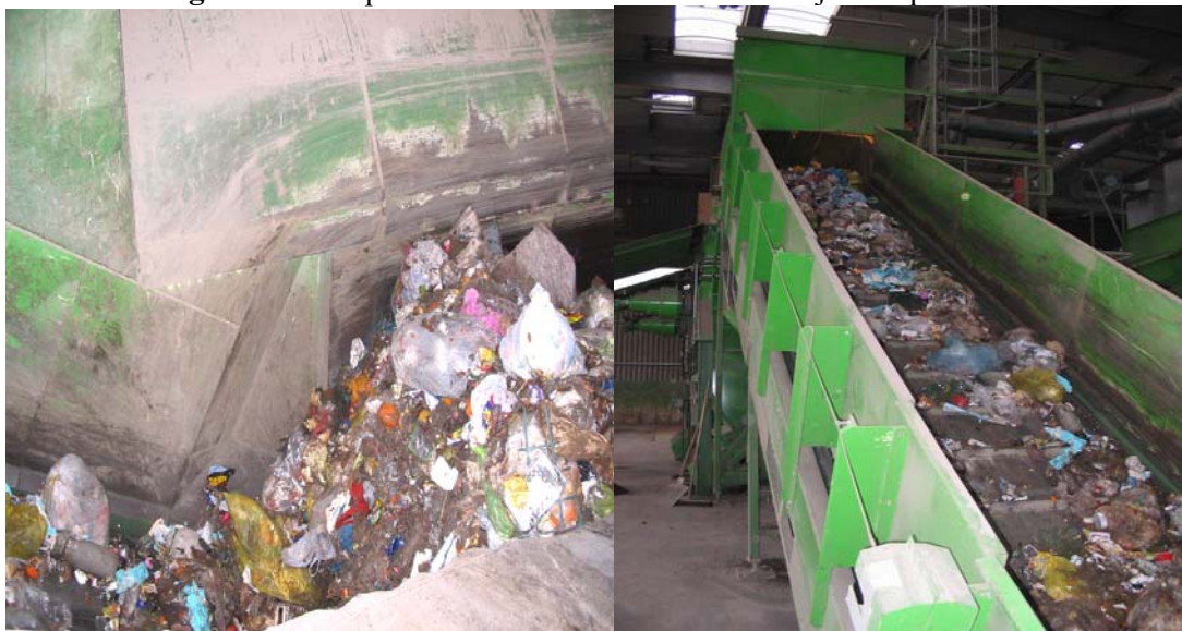
Figura 7. Transportul deseurilor din buncar la utilajele de prelucrare
