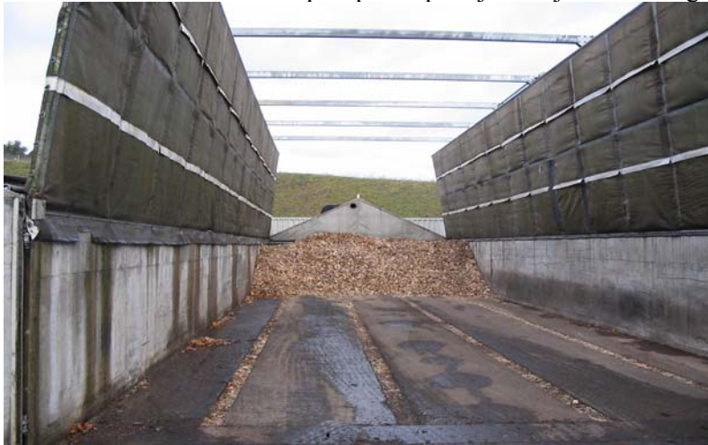
Figura 11. Vedere sistem aerare prin podea protejat cu ajutorul rumegusului
