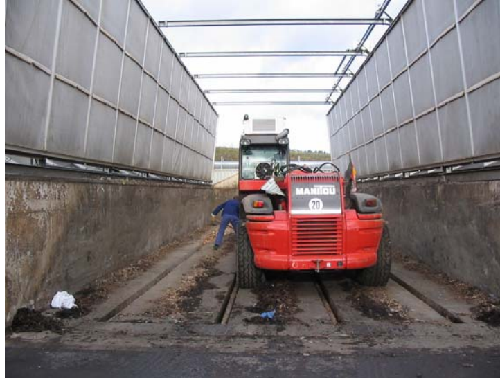
Figura 13. Intoarcerea compostului cu ajutorul tractoarelor
