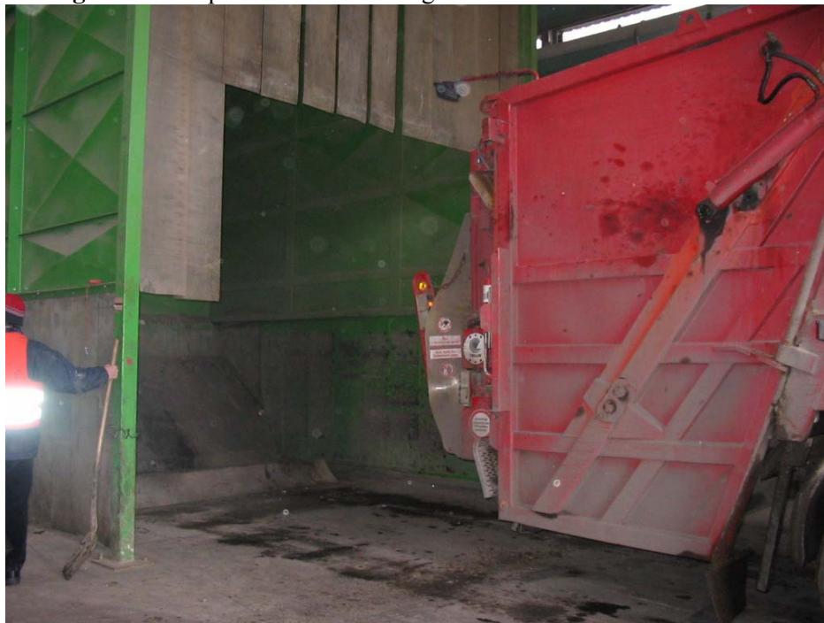
Figura 6. Receptia deseurilor biodegradabile in buncarul de descarcare
