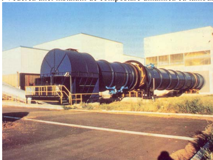
Figura 15. Vederea unei instalatii de compostare dinamica cu tambur de alterare
